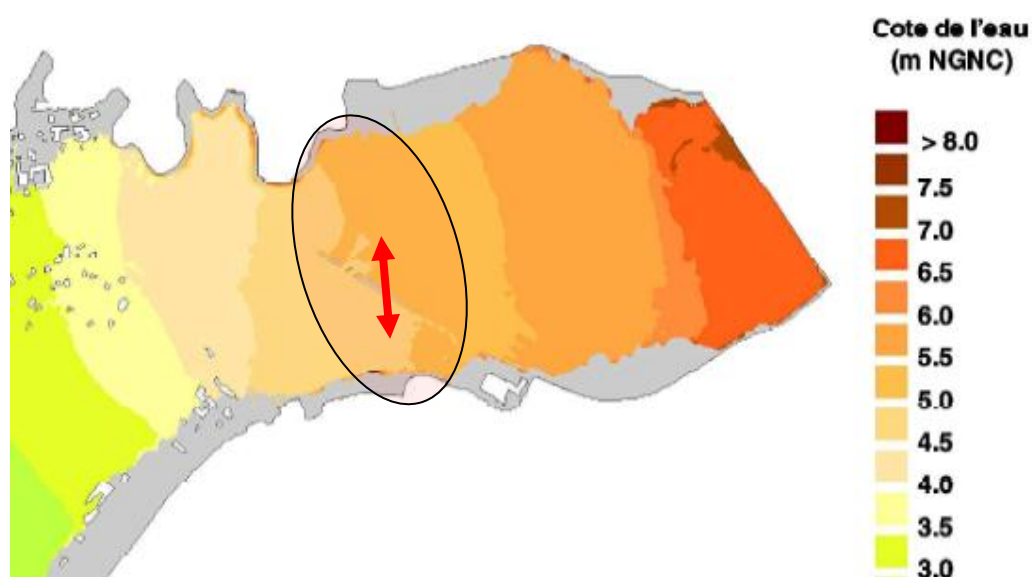
Figure 28 : Extrait carte des niveaux d'eau Q100 du modèle 2D de 2012 SOGREAH
